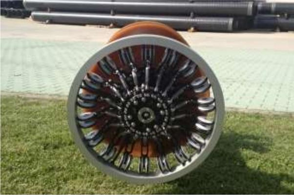
Il Caliper Pig misura continuamente il **diametro interno della tubazione** mediante un insieme di sensori che, caricati a molla al fine di tenerli in contatto con la parete della condotta, forniscono copertura ottimale della circonferenza interna. Le Drive-Cup in poliuretano, estremamente flessibili, consentono allo strumento di procedere agevolmente attraverso la tubazione. Il Caliper Pig è in grado di passare con riduzioni del diametro della condotta fino al 25%.
